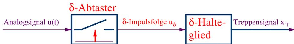
**Abb. 46** Modellierung der Abtastung und Speicherung
