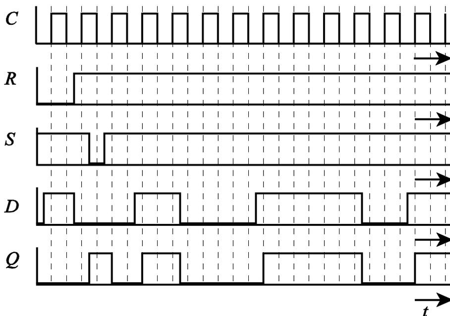
Abb. 8.4.9 Impulssdiagramm eines taktzustandsgesteuerten D-Flip-Flop mit Prioritätseingängen
