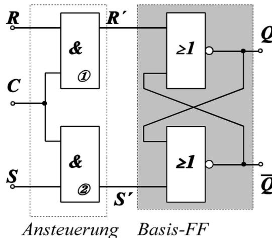
Abb. 8.4.3 Taktzustandsgesteuertes RS-FF
