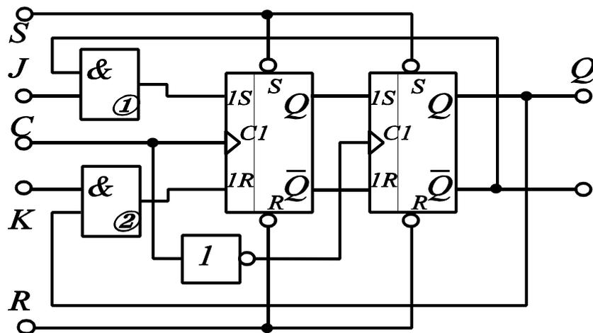
Innerer Aufbau eines taktflanken-gesteuerten JK-Master-Slave Flip-Flops mit Prioritätseingängen
