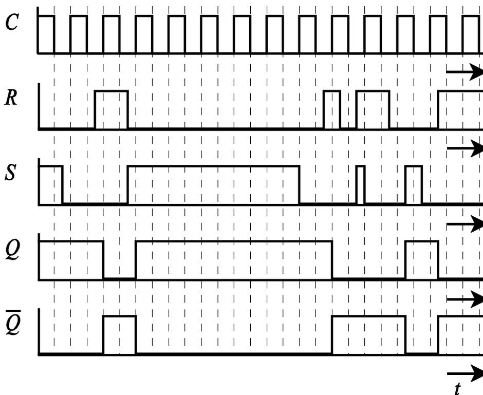
Impulszeitdiagramm eines taktzustandsgesteuerten RS-Flip-Flops
