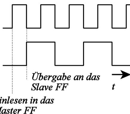
In dieser Beschaltung wechselt das FF mit jeder wirksamen Taktflanke seinen Zustand. Aus dem Impulsdiagramm (Abb. 8.4.21) sieht man, dass sich die Anzahl der Ausgangssignale halbiert hat. Man spricht von einem Teilungsverhältnis von 1:2. Durch Beschaltung mit weiteren JK-FF erhält man Frequenzteiler, die im Verhältnis  $1:2^n$  teilen können.
