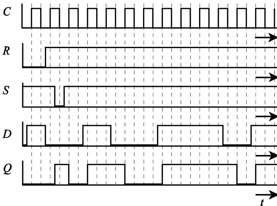
Impulszeitdiagramm eines taktflankengesteuerten Data-Flip-Flops mit Prioritätseingängen
