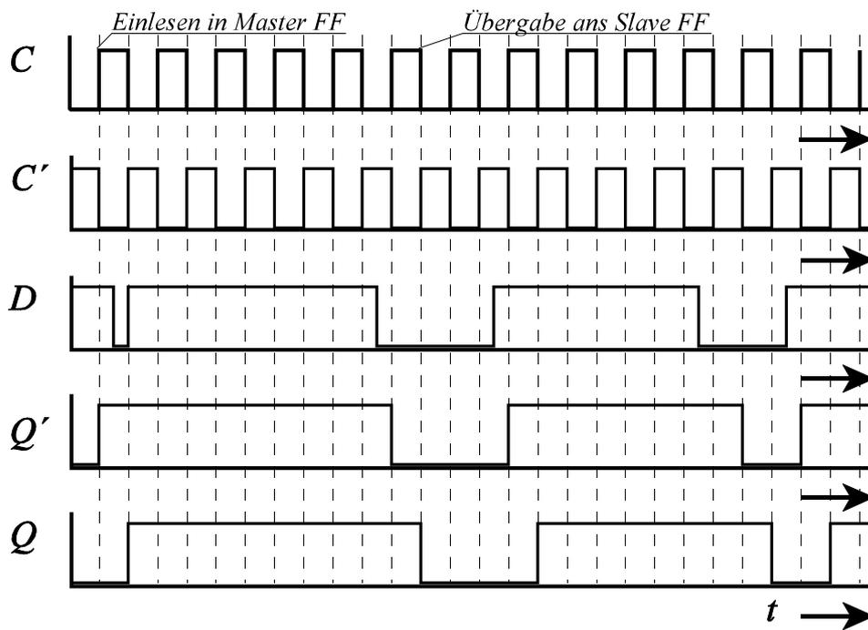
Impulszeitdiagramm eines taktflankengesteuerten Data-Master-Slave Flip-Flops
