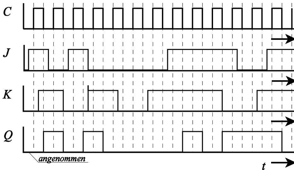
Impulszeitdiagramm eines taktflankengesteuerten JK-Master-Slave Flip-Flops
