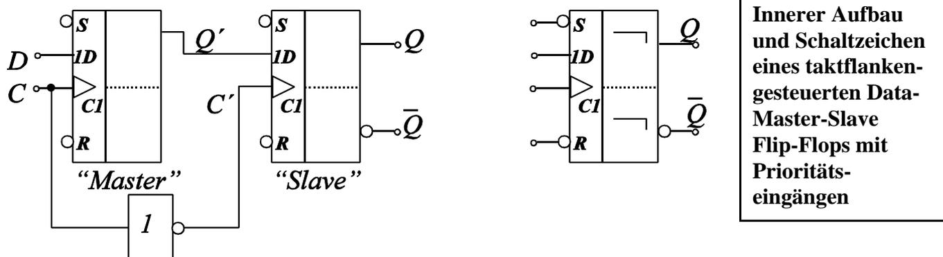
Abb. 8.4.11 positiv flankengetriggertes Data-Master-Slave-Flip-Flop
