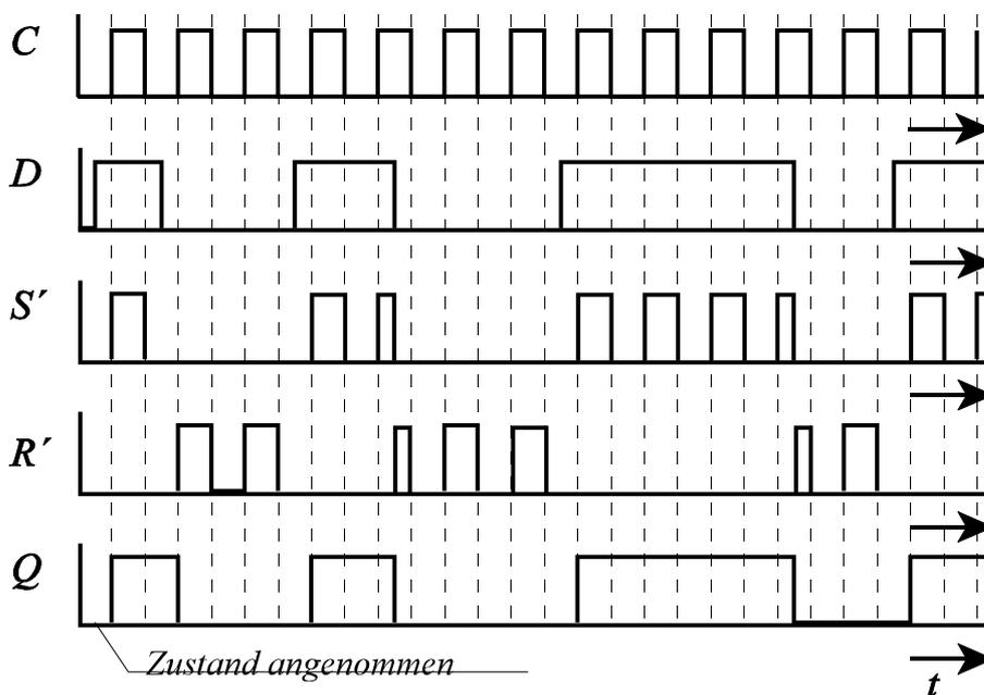
Abb. 8.4.6 Impulsdigramm für taktzustandsgesteuertes D-Flip-Flop (S' und R' sind die Signalpegel im Inneres des FF)
