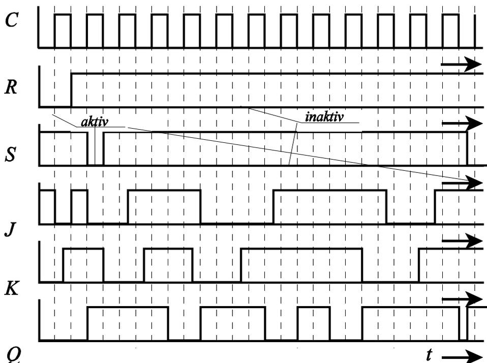
Impulszeit-diagramm eines taktflanken-gesteuerten JK-Master-Slave Flip-Flops mit Prioritätseingängen
