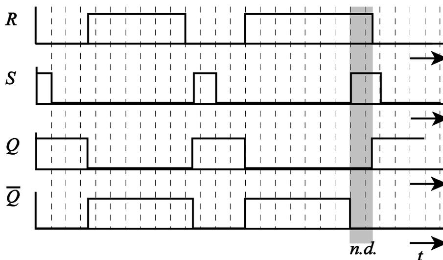
Impulszeitdiagramm für ein einfaches RS-Flip-Flop
