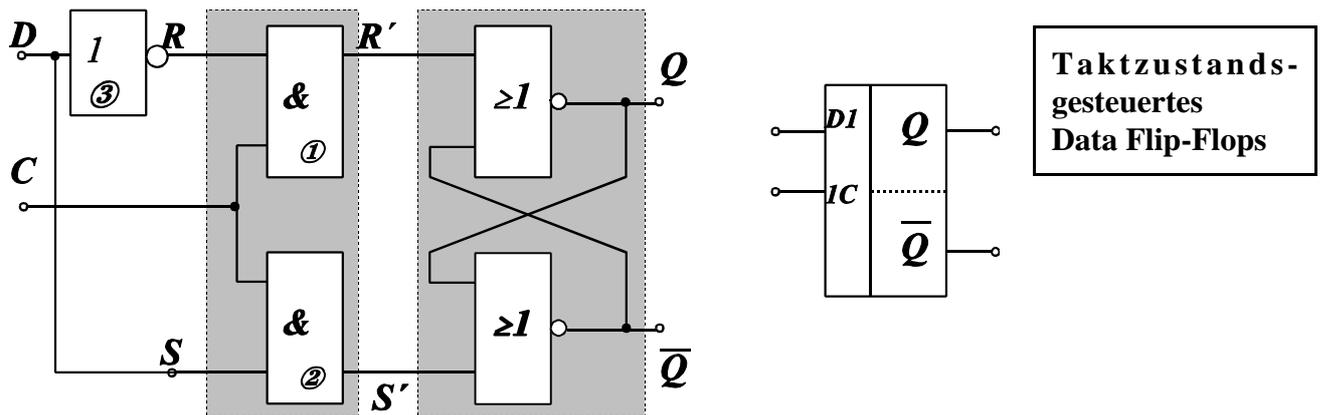
Abb. 8.4.5 Taktzustandsgesteuertes D-Flip-Flop
