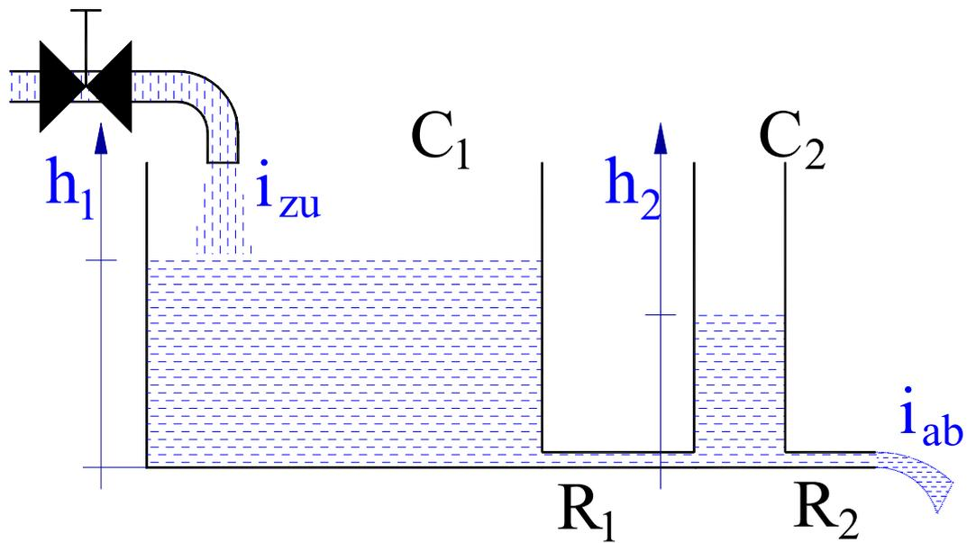
**Abb. 1** Hydraulisches  $PT_2$ -System
