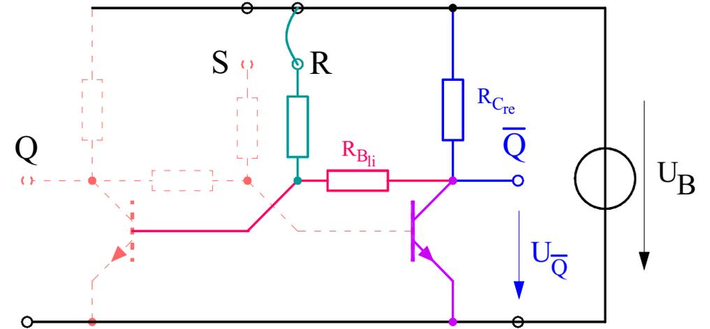
Linker Transistor schaltet durch
